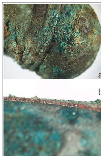
Fig. 4. M 200X, crustă grosă (secundară) și miez metalic parțial mineralizat, formațiuni de acoperire în relief.
