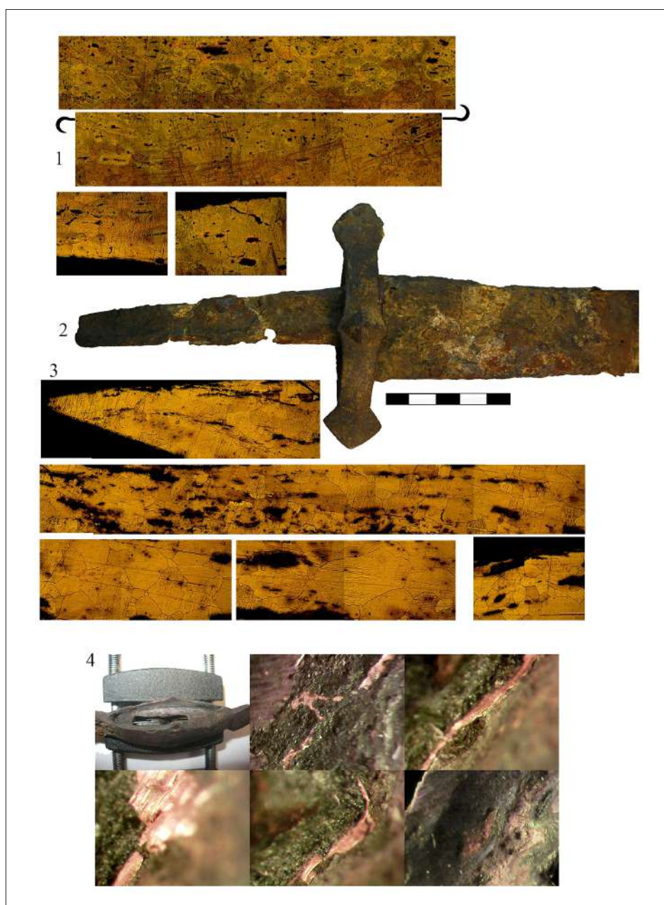
Рис. 3. Сабля №1, увеличенные фрагменты шлифов и следы пайки медью на крестовине.
