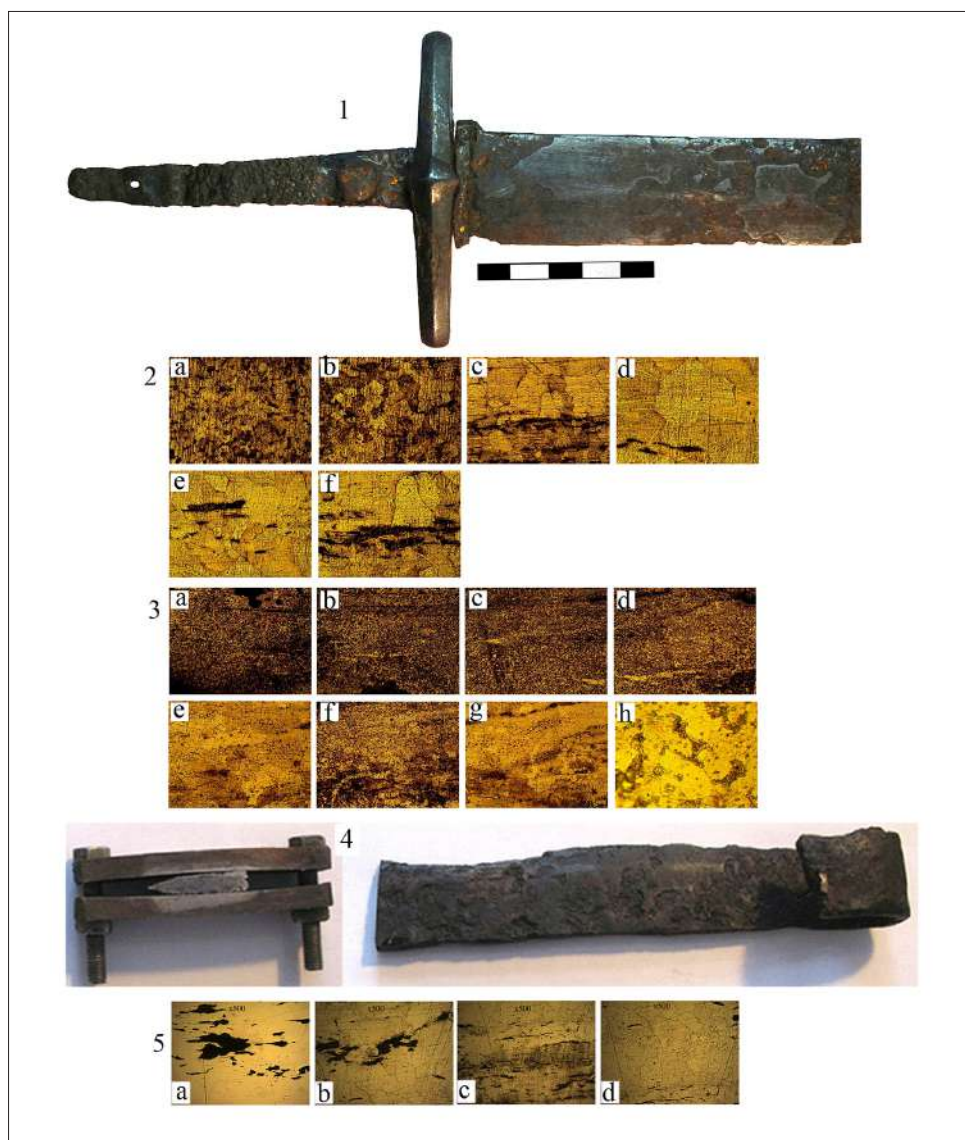
Рис. 5. Сабля №3, фрагмент клинка №4 и увеличенные фрагменты шлифов.
